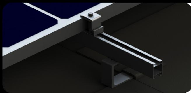
Com o grampo terminal no perfil. Certificar-se de que todos os contatos sejam feitos. Fixar os parafusos dos grampos com torque de 15Nm e depois do aperto verificar se os módulos ficaram corretamente fixados.
