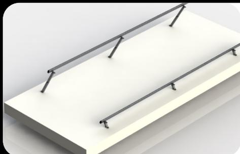
Inserir o parafuso cabeça martelo nos suportes angulares e fixar os perfis. Realizar a operação para os pés dianteiros e traseiros.
